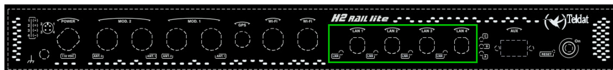
Fig. 3: LAN Switch ports (4)
